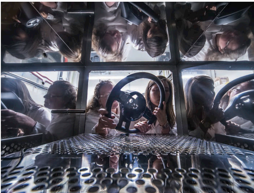
U komori za komponente veličine jednog kubnog metra, ocjenjuju se velike komponente u očuvanom stanju pri 65 stupnjeva. Na taj način se sprečavaju precjenjivanja presječnih površina koje isparavaju.
