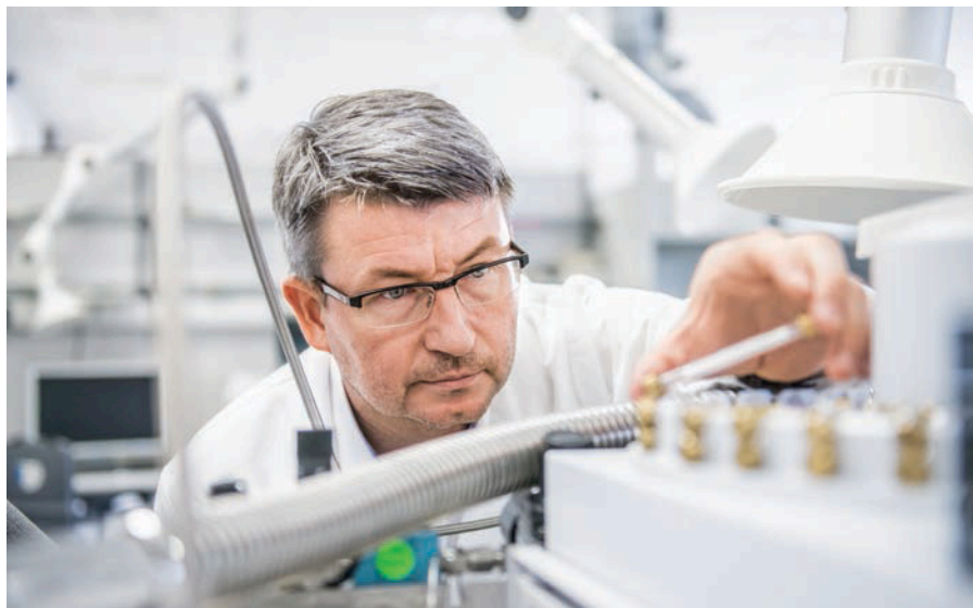
U analitici emisija Jörg Göldenitz identificira lakohlapljive supstance pomoću uzoraka zraka. One se filtriraju iz zraka pomoću apsorpcijskih cjevčica.
